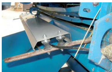
Sensor strat zamocowany jest na wysięgnikach za pośrednictwem gumowych amortyzatorów.
